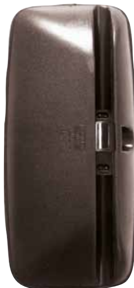
Dim : 420 x 200 mm Réversible Fixation Ø 18 mm Pour Renault
